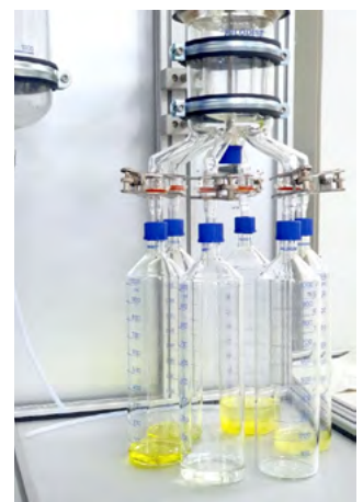
oben: Mehrstufiger Vakuumverdampfer.
