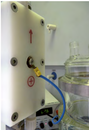
Laborzelle zur anodischen Oxidation und kathodischen Reduktion.
